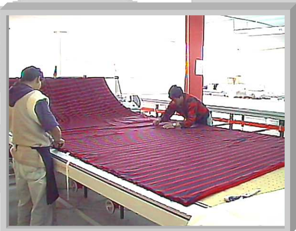
Spanuitul se face functie de pozitia acelor
